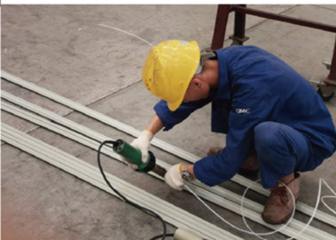
PP 塑料型材的焊接 LST1600S
