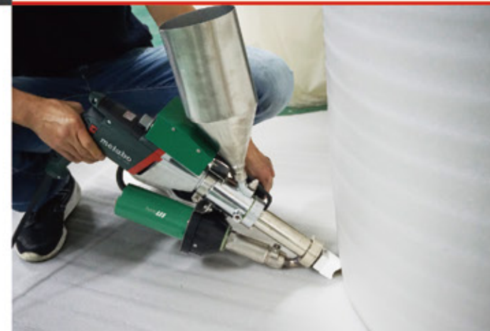
塑料管道的焊接 LST620
