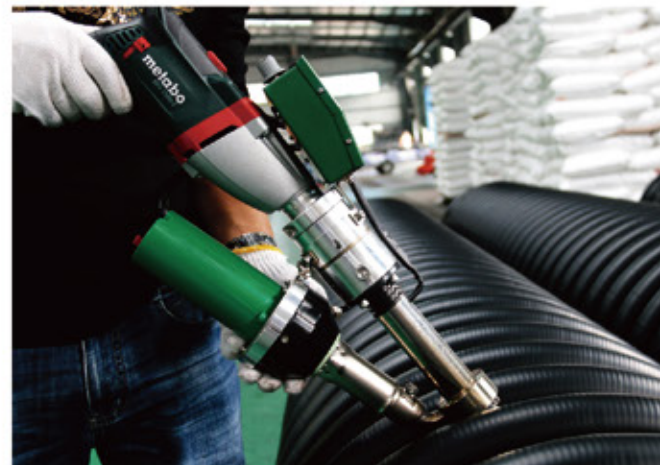
塑料管道的焊接 LST610C
